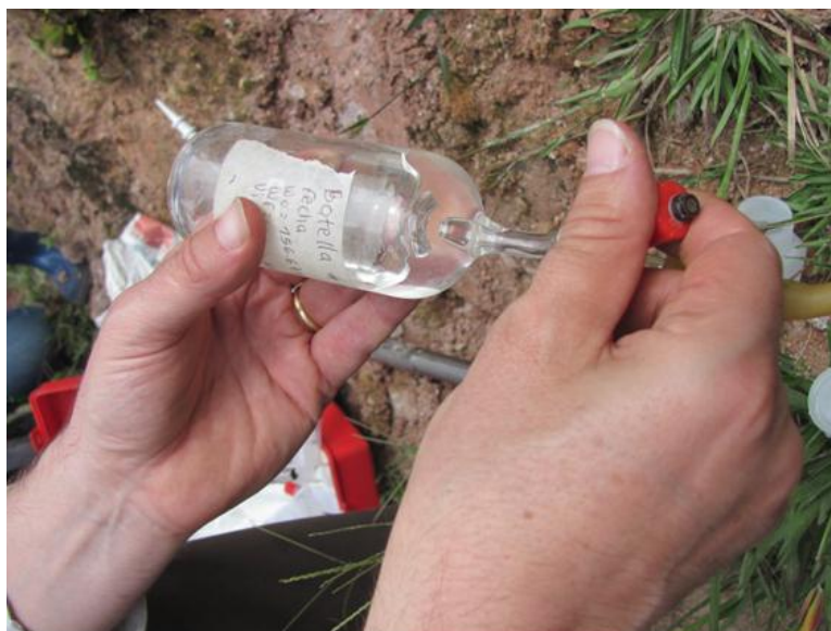
Figura 78. Modo de muestreo Directo con Botellas de Giggenbach en la Fumarola La Macha. Volcán Cerro Machín.
